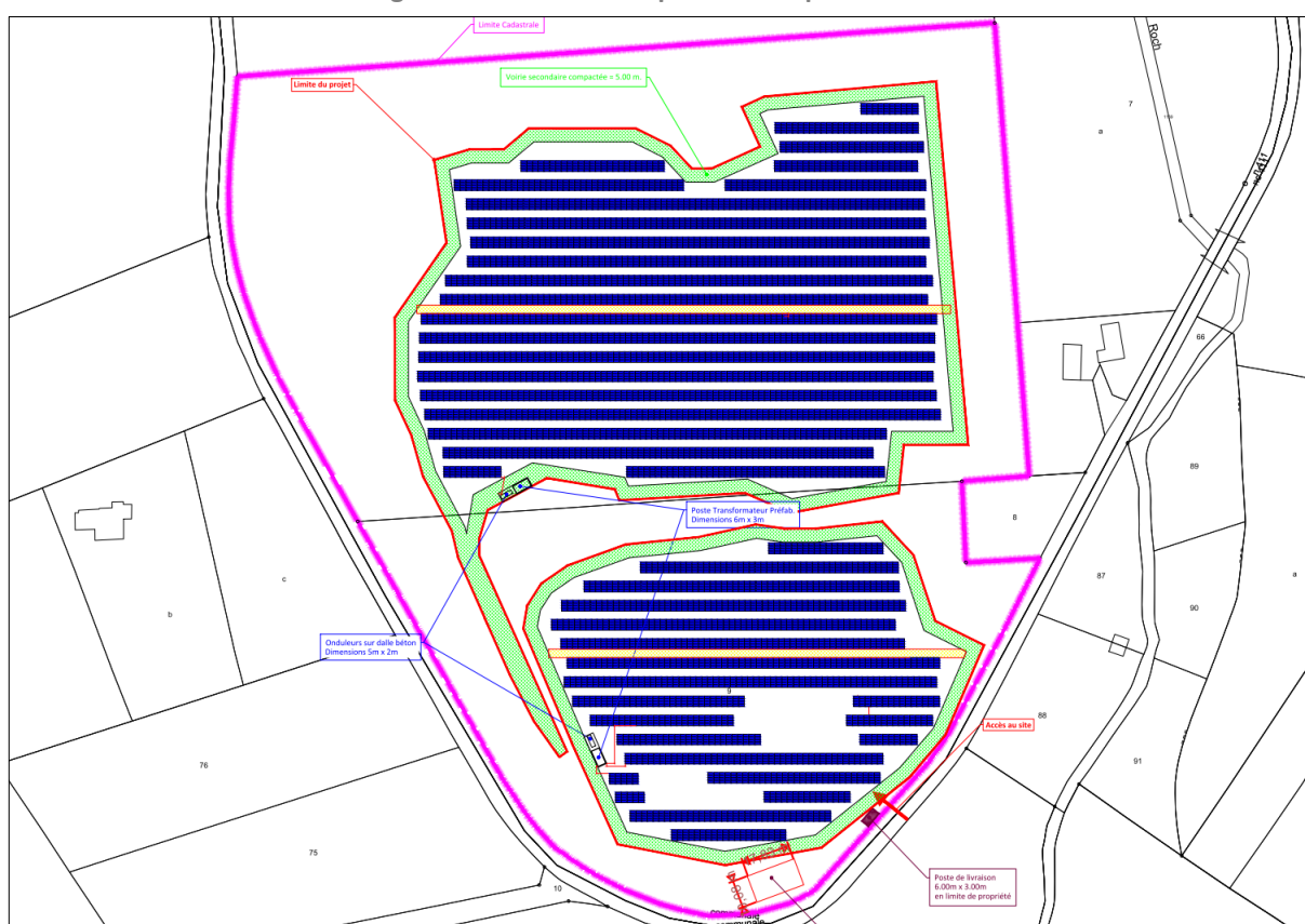
Illustration 4 : Schéma d'aménagement de la centrale photovoltaïque
